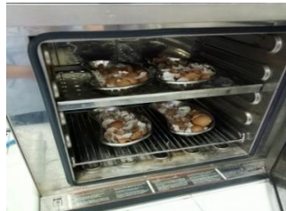
Pengeringan canggang telur ayam dengan oven 110°C
