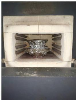
Kalsinasi canggang telur ayam pada suhu 1000°C
