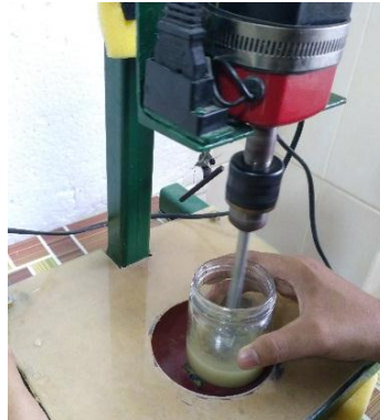
Gambar 3.36 Pencampuran Matriks dan Mikrosilika
