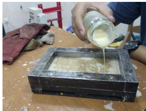
Gambar 3.37 Penuangan Matriks dan Mikrosilika
