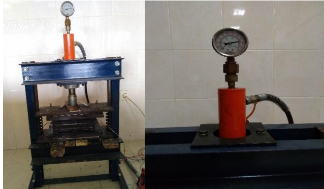
Gambar 3.38 Proses press dengan Mesin Hot Press
