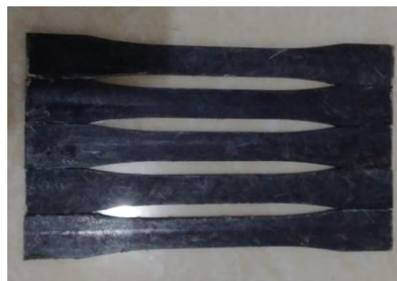
Gambar 2.1 Spesimen komposit hibrid abaka/karbon/PMMA siap uji tarik ASTM D638-01
