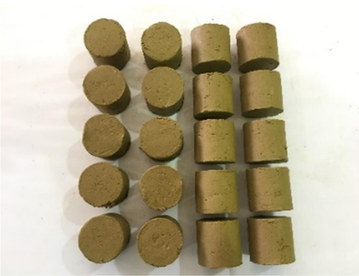
Gambar 2 Spesimen A2 (Bentuk Sampel Silinder 34,5 mm x 34,5 mm)
