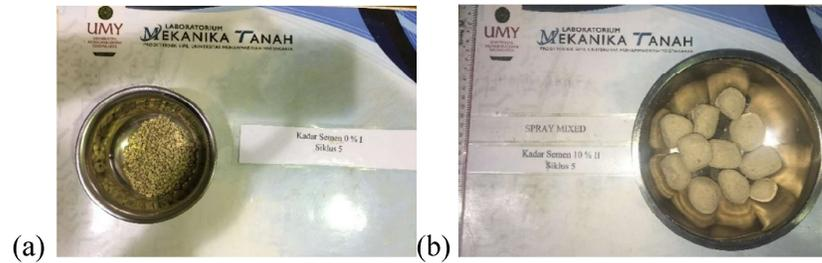
Gambar 3.14 Sampel (a) kadar semen 0% dan (b) Kadar Semen 10% setelah 5 siklus
