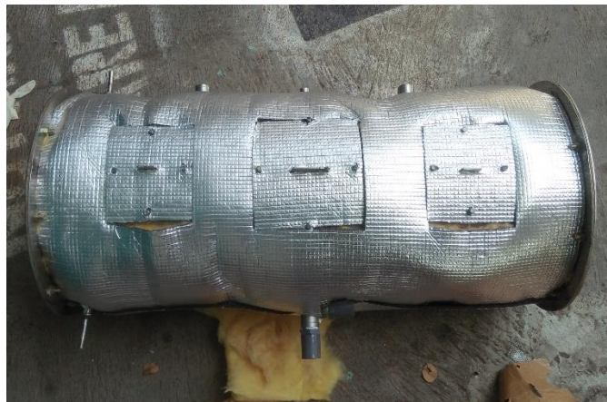
Gambar 3. 7. Tangki solar water heater sudah terpasang glasswool dan aluminium.
