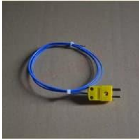
Gambar 3. 15. Termokopel tipe K.
