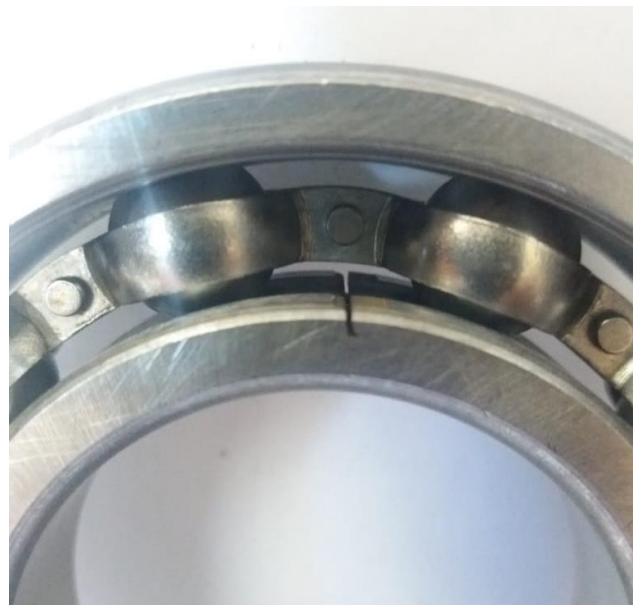
Gambar 3.3 Bantalan cacat lintasan dalam
