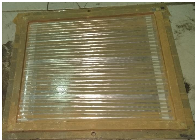
Gambar 3.22. Susunan serat gelas searah
