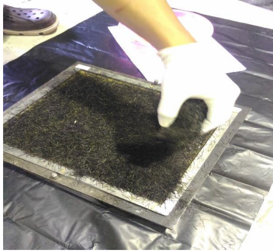
Gambar 3.24. Proses penaburan serat ijuk acak
