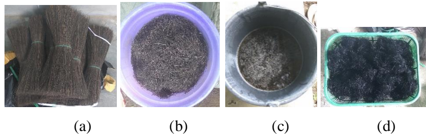
Gambar 3.16. Proses perlakuan serat ijuk (a). Pemilihan ijuk; (b). Pemotongan ijuk; (c). Proses pencucian ijuk; (d). pengeringan ijuk
