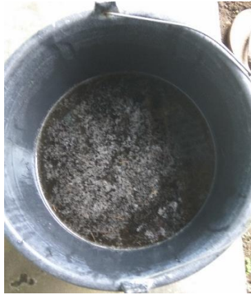
Gambar 3.17. Proses perendaman dengan alkali
