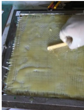
Gambar 3.23. Proses pembasahan serat gelas
