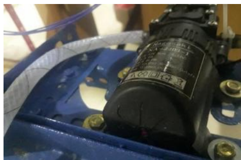
Gambar 3. 23 Pompa DC 12 V
