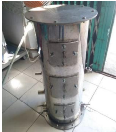
Gambar 3. 6 Tangki SWH belum terpasang glasswool dan aluminium foil
