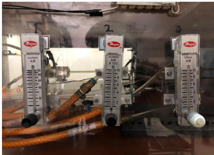
Gambar 3.4 Flowmeter udara
