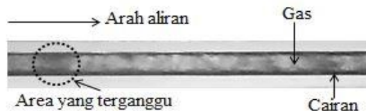
Gambar 6. Pola aliran churn pada J_G = 50 m/s, J_L = 0,879 m/s
