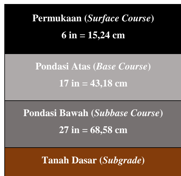
Gambar 4. 1 Hasil tebal perkerasan lentur runway dengan metode CBR
