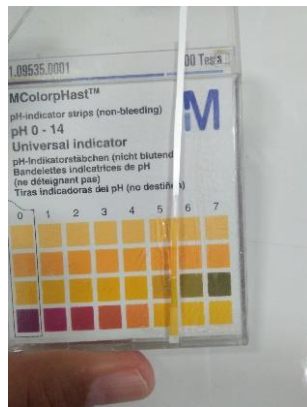
Pengukuran pH menggunakan pH stik
