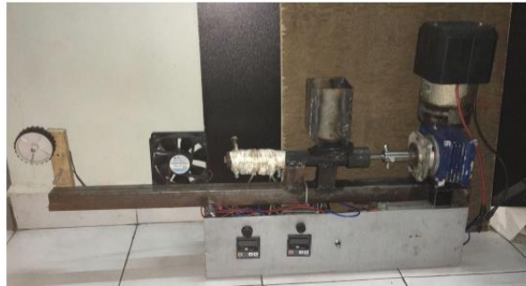
Gambar 2.3. Mesin Extruder rancangan Wankhade dan Satish (Wankhade dan Satish, 2018)
