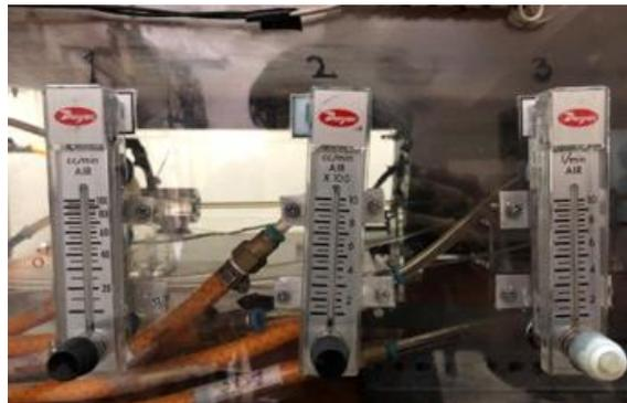
Gambar 3.17. Tiga *flowmeter* Udara
