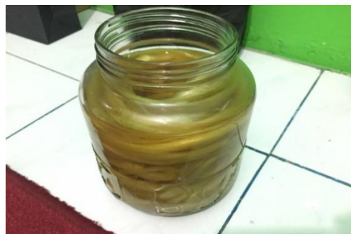
Gambar 3. 23 Proses alkalisasi serat dalam larutan NaOH
