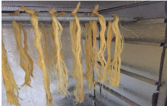
Gambar 3. 22 Proses pengeringan serat
