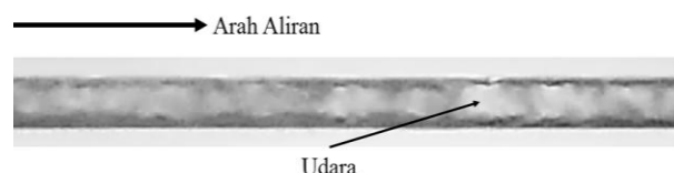
Gambar 6. Pola aliran churn pada J_G = 66,3 m/s, J_L = 2,297 m/s
