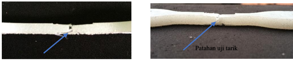
a. Gambar spesimen setelah uji tarik
