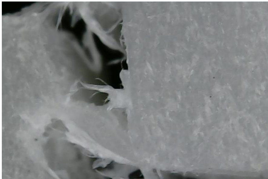
b. Patahan setelah uji tarik
