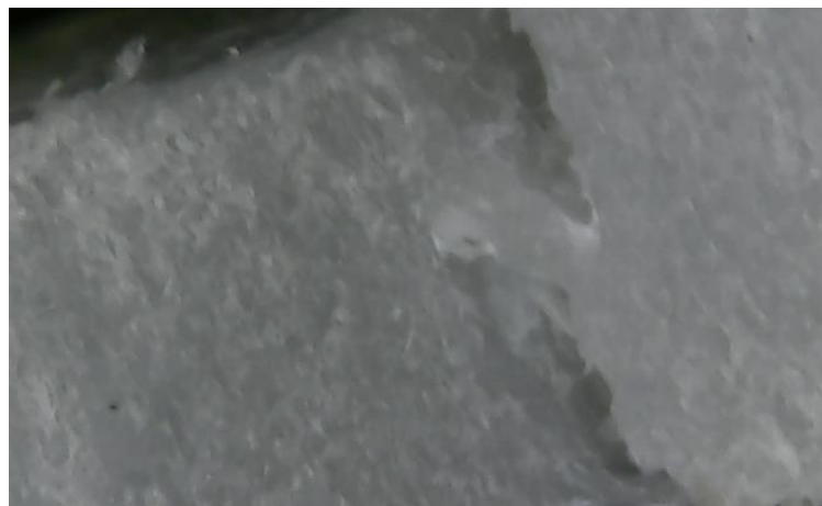
c. Patahan setelah uji tarik
