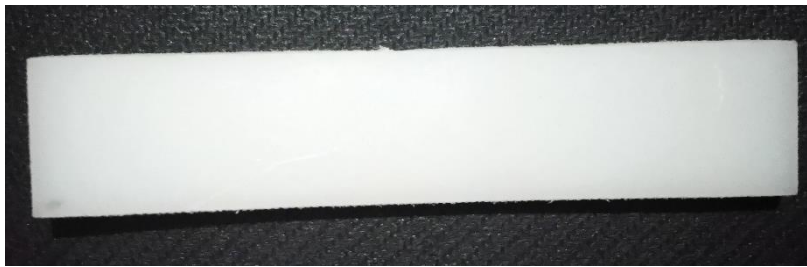
Gambar 3.25 Spesimen Uji Bending ASTM D790
