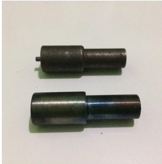
Gambar 3.18 pin tool silinder ulir dan tool sholder saja
