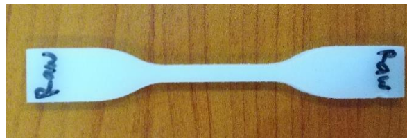
Gambar 3.22 Spesimen uji tarik ASTM D638 Type IV
