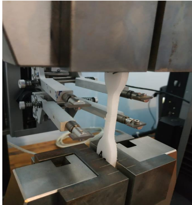
Gambar 3.20 proses uji tarik
