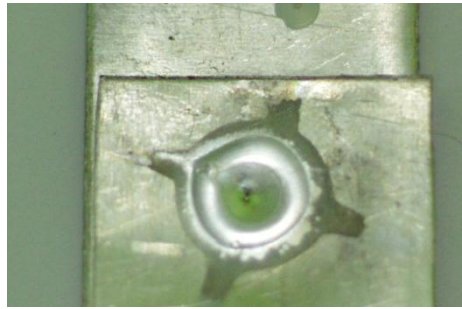
Gambar 2.4 Permukaan nugget dengan Spot TIG welding material AL
