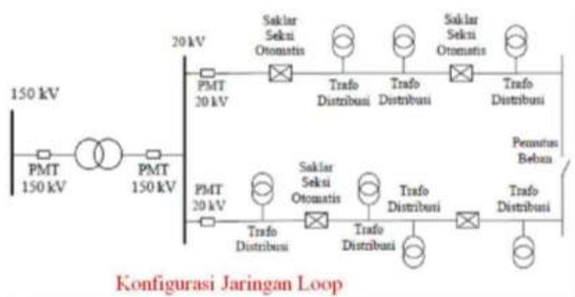
Gambar 2.7. Konfigurasi Jaringan Loop
