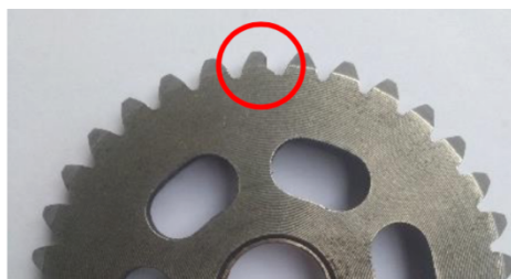
Gambar 2. Rusak satu buah gigi sebagian ( \frac{1}{2} diameter 1,5mm)
