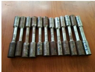
Gambar 4.11 Contoh spesimen pengujian kekuatan tarik kondisi I dan kondisi II
