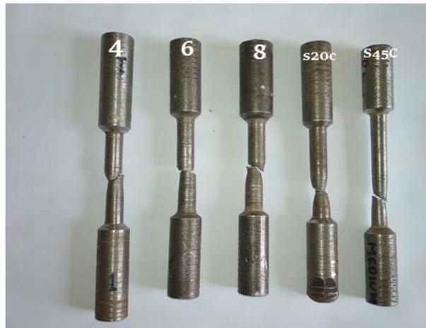
Gambar 4.16 Hasil patahan proses pengujian tarik kondisi I
