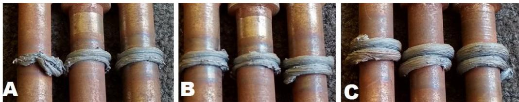
Gambar 4.1 Contoh hasil pengelasan kondisi I dan kondisi II, (A) waktu gesek 4 detik, (B) waktu gesek 6 detik, (C) waktu gesek 8 detik.
