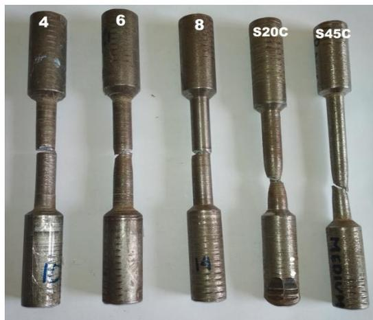
Gambar 4.17 Hasil patahan proses pengujian tarik kondisi II
