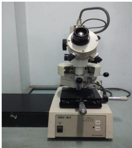
Gambar 3.9 Mesin Uji Kekerasan
