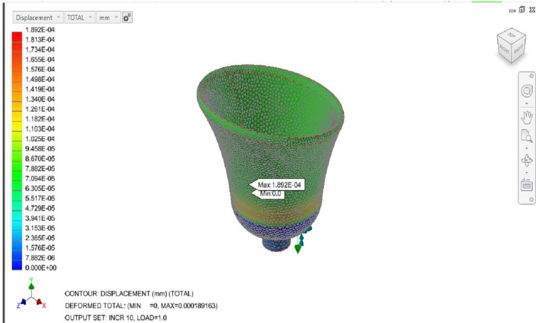
Gambar 4.8 3D simulasi *displacement*
