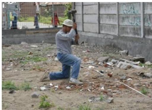
Gambar 7.12: Sumber gelombang mekanik yang digunakan
