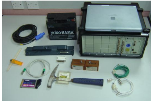
Gambar 4.11: Satu set penganalisis spektrum PULSE dan aksesoriya yang digunakan dalam pengukuran
