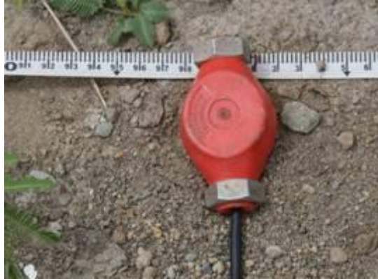
Gambar 7.10: Sensor geophone untuk frekuensi natural 28 Hz
