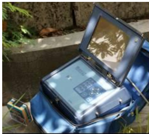
Gambar 7.11: Alat seismograf untuk perekaman data gelombang permukaan
