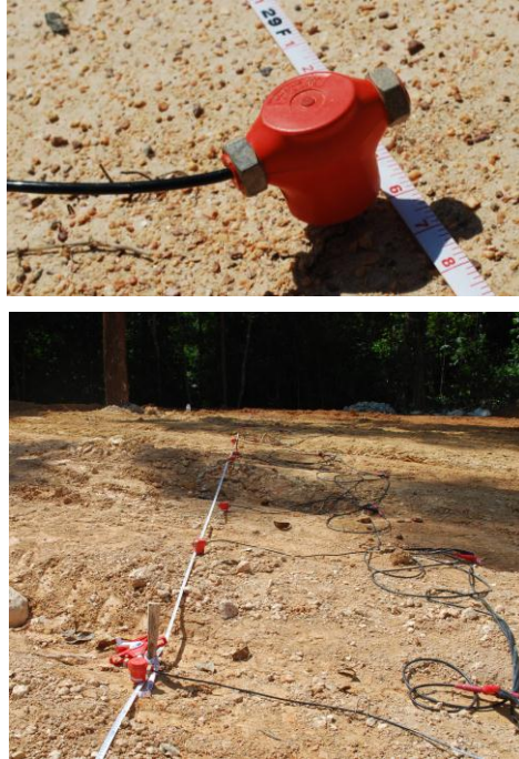
Gambar 7.2: Jenis sensor geofon yang digunakan dalam pengukuran MASW
