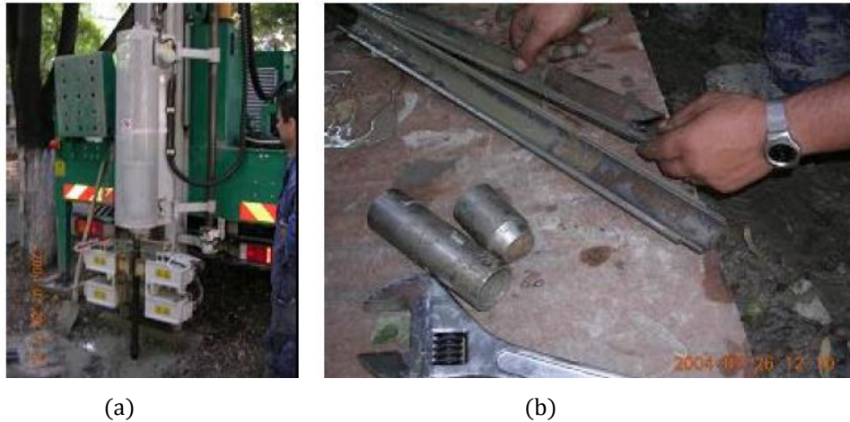
Gambar 1.9: (a) Pelaksanaan pengujian SPT untuk penyelidikan tanah dan (b) pengambilan sampel tanah yang dilakukan (Arion et al. ,2007)
