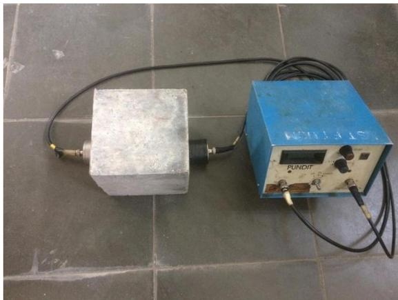
Gambar 4.9 Pengujian Densitas Menggunakan *Ultrasonic Pulse velocity Test (UPVT)*
