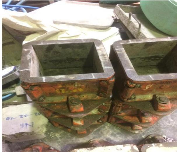
Gambar 3.18 Cetakan Beton Segar
