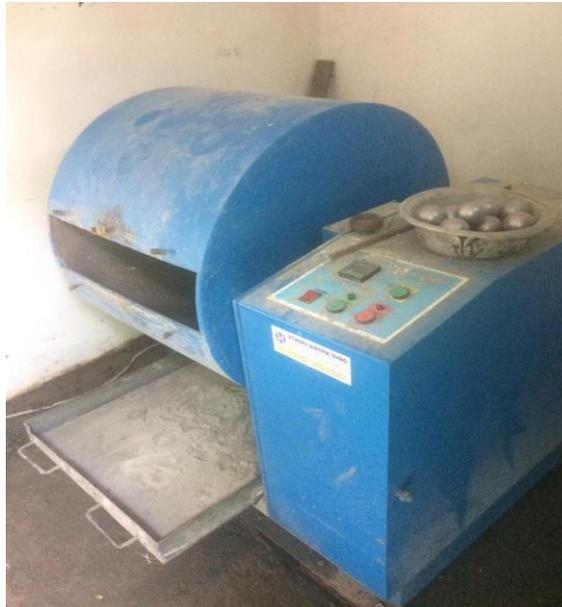
Gambar 3.10 Mesin Abrasi
