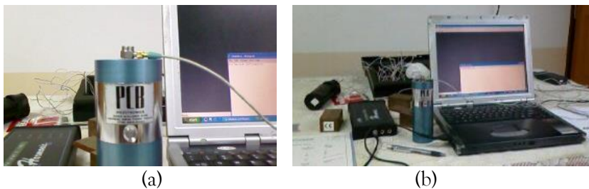
Gambar 4.9: (a) Proses kalibrasi sensor; kalibrator dan sensor dan (b) susunan konfigurasi dalam proses kalibrasi (Rosyidi, 2013)
