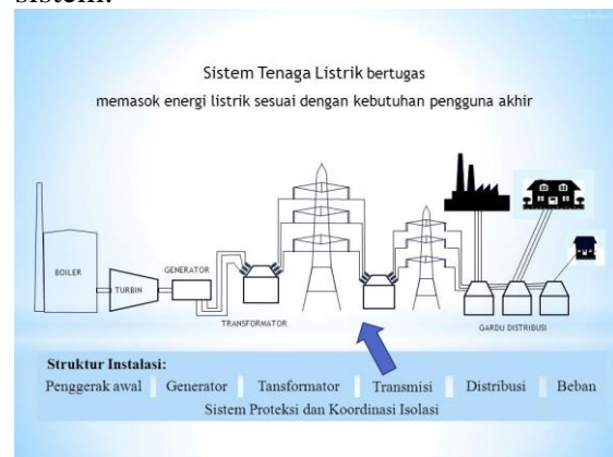
Gambar 1. Sistem Tenaga Listrik
