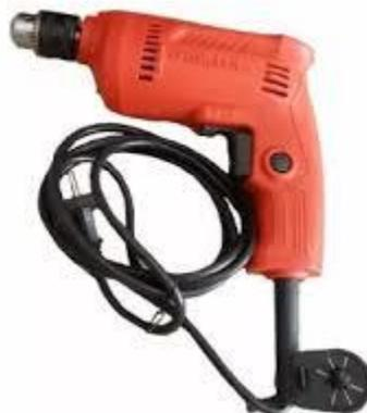
**Gambar 3.18** Mesin bor tangan
