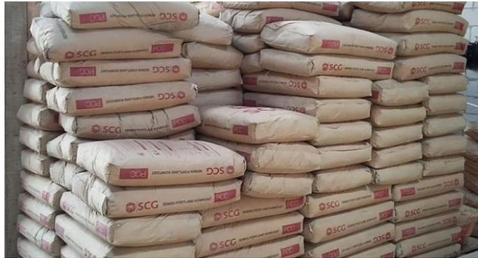
**Gambar 2.14.** Contoh material satuan (*unit load*)
