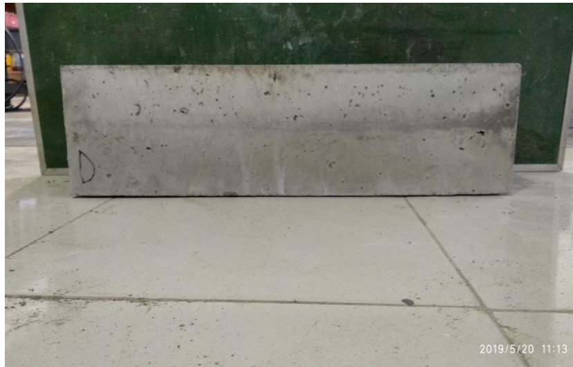
Gambar 5. Hasil pembuatan beton cold joint
