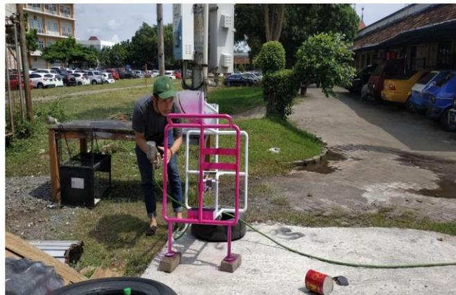
Gambar 4. 7 Proses Pengecatan Inti
