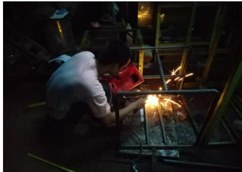
Gambar 4. 4 Peoses Pengelasan Rangka
