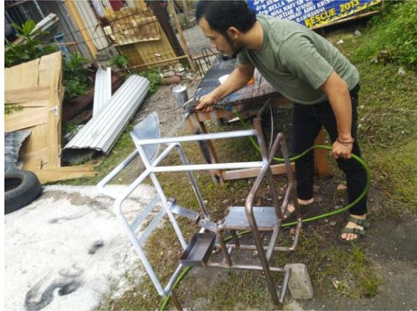
Gambar 4. 6 Proses Pengecatan Epoxy
