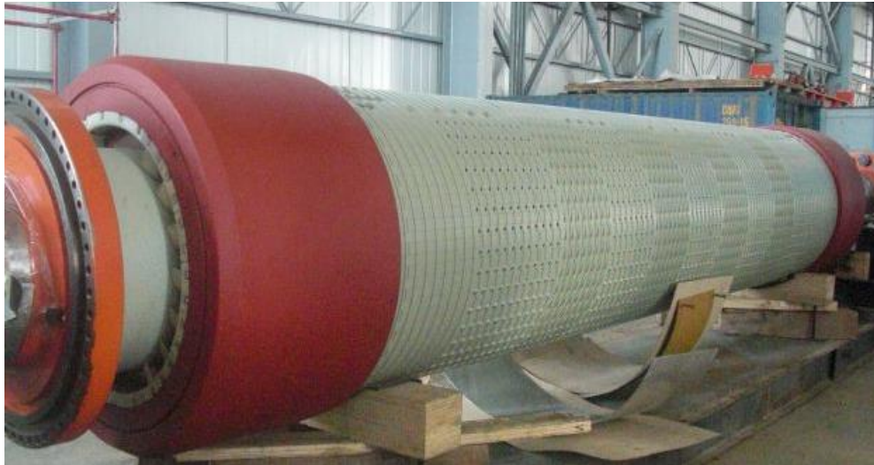
Gambar 2. 2 Konstruksi rotor (Sumber: Rizhal,2013)
