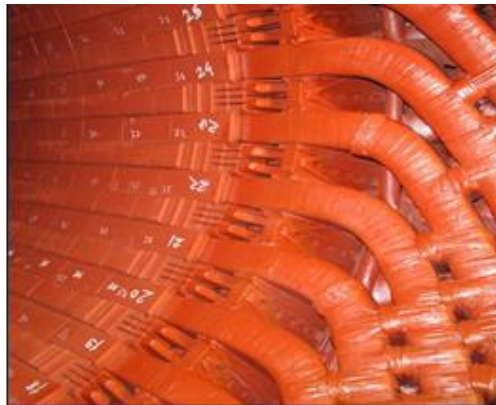
Gambar 2. 9 Konstruksi kumparan jangkar stator (Sumber: Anonim, 2016)
