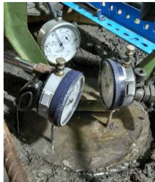
Gambar 3. 10 Pemasangan magnetic dial gauge
