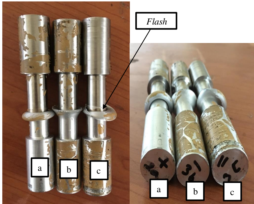
Gambar 4.1. Hasil Sambungan, (a) permukaan gesek AL chamfer , (b) permukaan gesek SS chamfer , (c) permukaan gesek tanpa chamfer .
