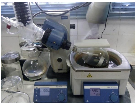
Gambar 3. Proses pemanasan menggunakan Rotary Vacuum Evaporator untuk memekatkan ekstrak
