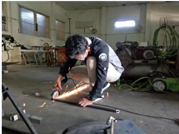
Gambar 4.7 Proses pemotongan baja karbon sedang profil kotak
