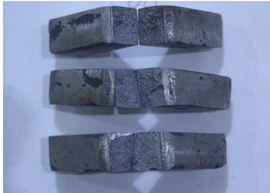
Gambar 4.9 Sepesimen uji quenching media air (Laboraturium Bahan Teknik UGM. 17 Juli 2019)
