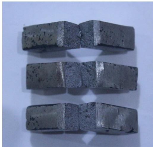
Gambar 4.8 Sepesimen uji quenching media oli (Laboratorium Bahan Teknik UGM. 17 Juli 2019)
