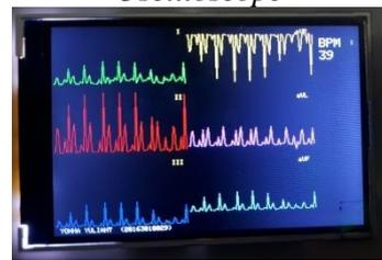
Gambar 3.7 Tampilan Sinyal Semua Lead Pada LCD TFT
