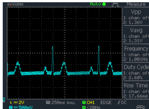
Gambar 4.105 Lead AVF Dengan Sensitivitas 1mv Pada Tampilan Oscilloscope
