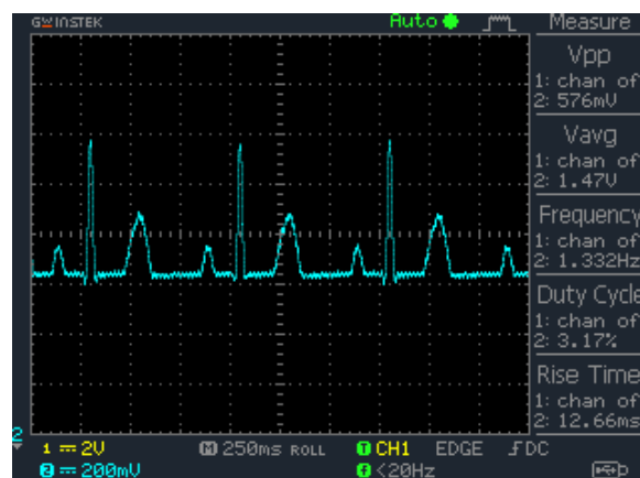
Gambar 4.94 Lead I Dengan Sensitivitas 0,5mv Pada Tampilan Oscilloscope
