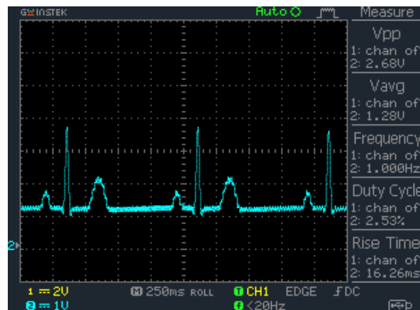
Gambar 4.111 Lead AVF Dengan Sensitivitas 2mv Pada Tampilan Oscilloscope
