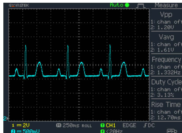
Gambar 4.100 Lead I Dengan Sensitivitas 1mv Pada Tampilan Oscilloscope
