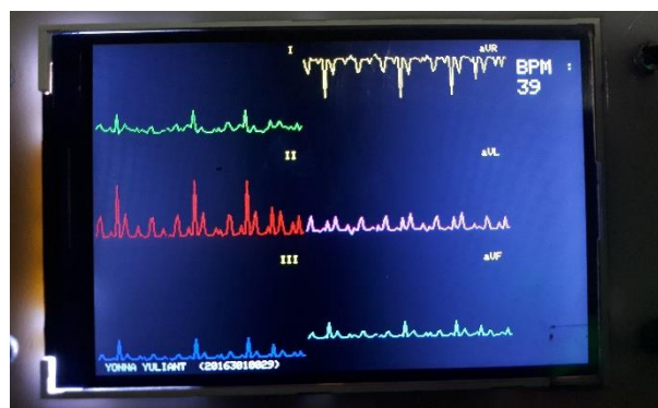
Gambar 4.123 Hasil Sinyal Dengan Sensitivitas 1mv Pada Tampilan LCD TFT
