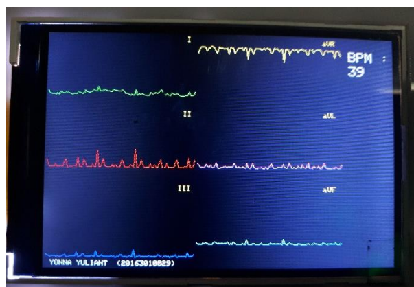
Gambar 4.122 Hasil Sinyal Dengan Sensitivitas 0,5mv Pada Tampilan LCD TFT
