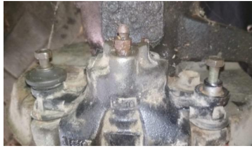
Gambar 4.31 Baut pengunci kaliper
