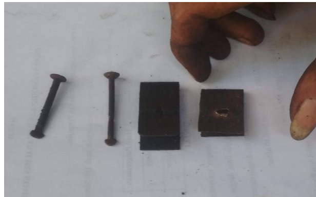
Gambar 4.23 Penggantian pengunci sepatu rem
