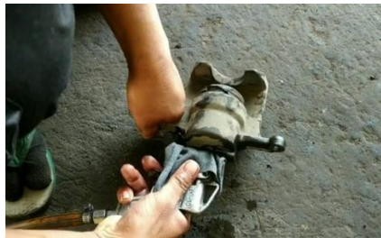
Gambar 4.12 Pemeriksaan piston kaliper
