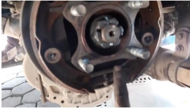
Gambar 4.25 Pasang sepatu rem dan penyetel otomatis hand rem
