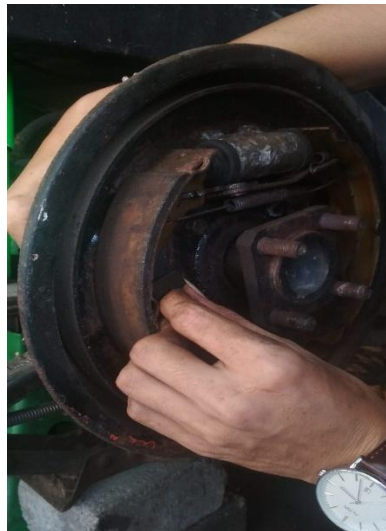
Gambar 4.26 Pemasangan sepatu rem belakang
