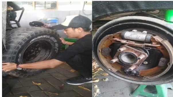
Gambar 4.5 Melepas roda dan Tromol
