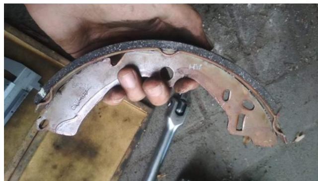
Gambar 4.6 Melepas Sepatu Rem
