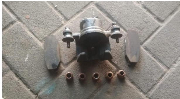
Gambar 4.3 Mengeluarkan kaliper dan copot pad rem
