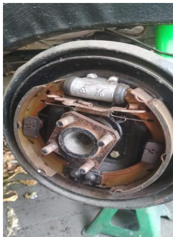
Gambar 4.8 Membersihkan komponen dengan kain dan kompresor dari debu.
