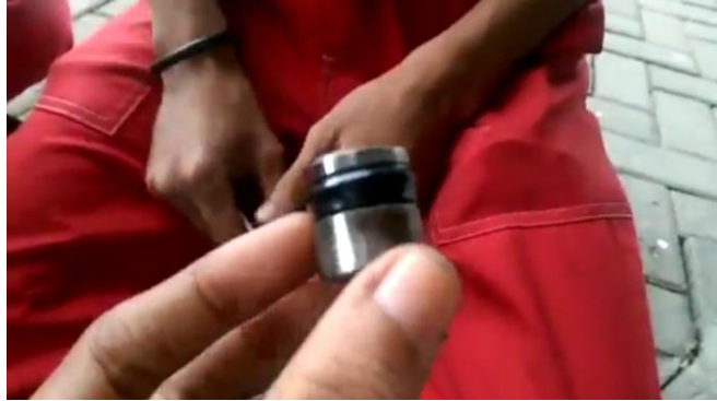
Gambar 4.22 Penggantian kampas rem dan seal piston silinder
