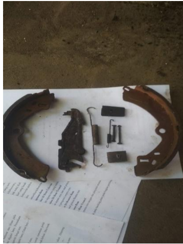
Gambar 4.7 Lepas komponen pada plat penahan.
