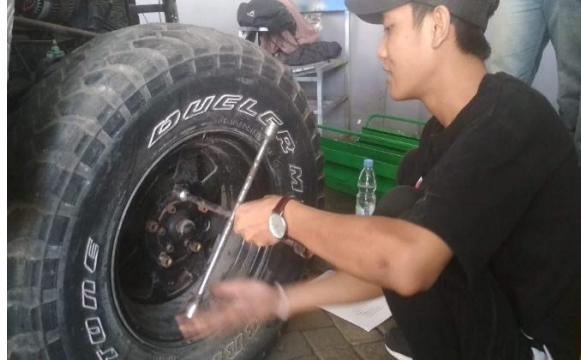
Gambar 4.1 Melepas Baut Roda
