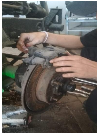
Gambar 4.32 Pemasangan kaliper rem cakram
