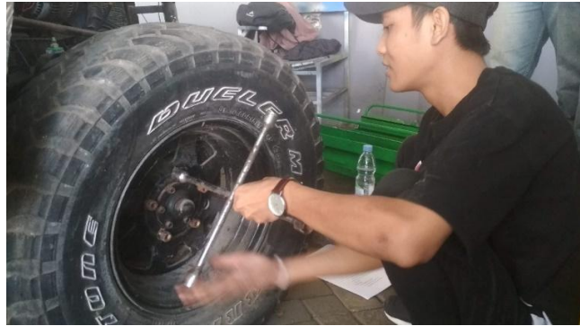
Gambar 4.4 Melepas Baut Roda
