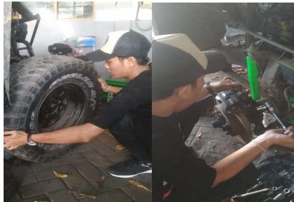
Gambar 4.2 Lepas roda dan bat kaliper rem cakram.
