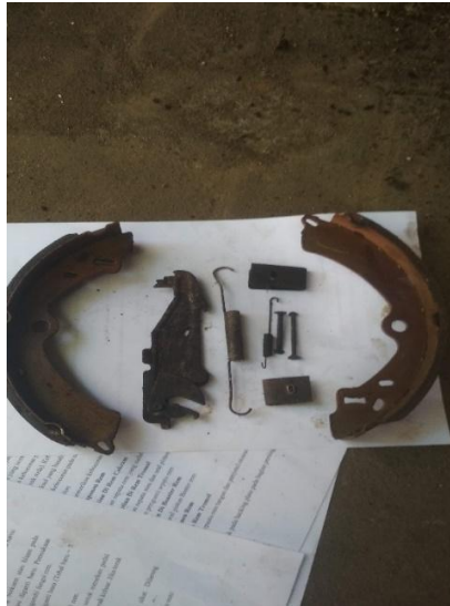
Gambar 4.16 Pemeriksaan komponen pengikat sepatu rem
