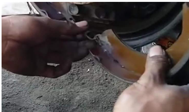
Gambar 4.27 Pemasangan pegas pengembali
