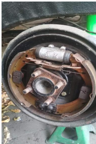
Gambar 4.15 Membersihkan komponen rem tromol
