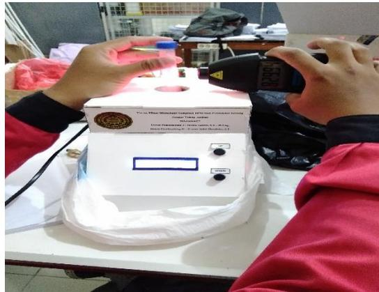
**Gambar 3.11** Pengukuran Dengan *Tachometer*.
