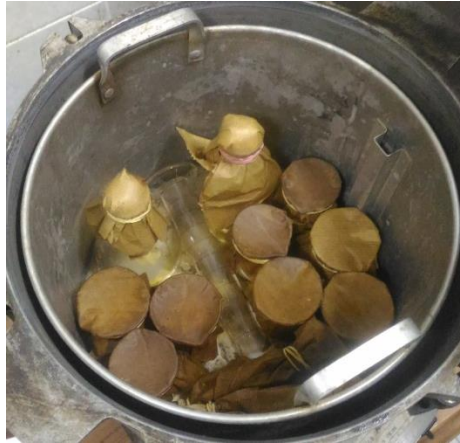
Gambar 18. Alat disterilisasi dalam autoklaf
