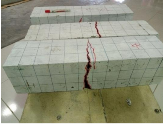
Gambar 4.23 Pola retakan dengan variasi kaolin 15%
