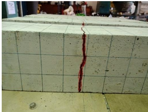
Gambar 4.22 Pola retakan dengan variasi kaolin 10%
