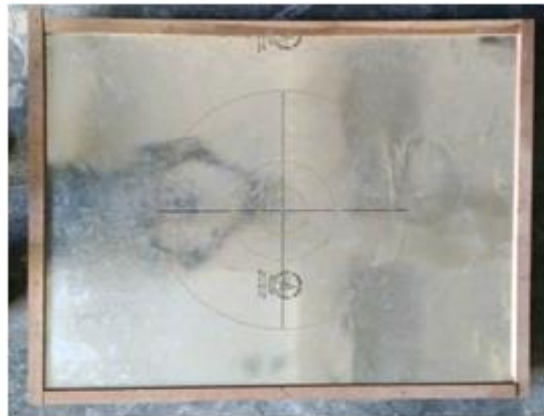
Gambar 3.1 Alat pengujian Meja Sebar (T50)
