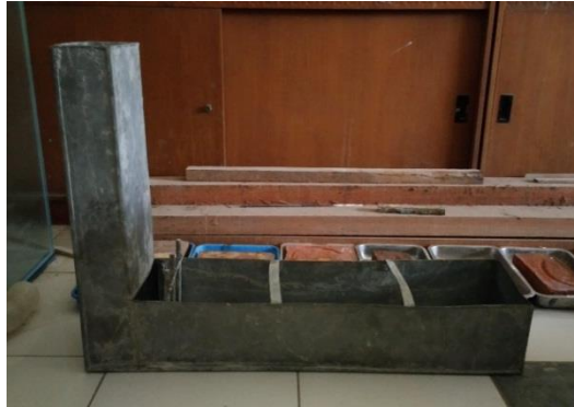
Gambar 3.3 Alat pengujian L-Box
