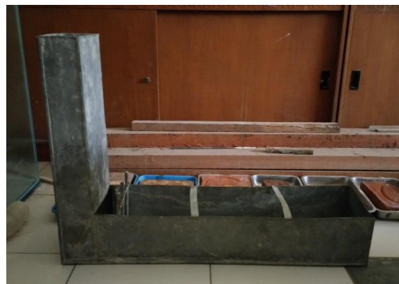
Gambar 16 Alat pengujian L-Box
