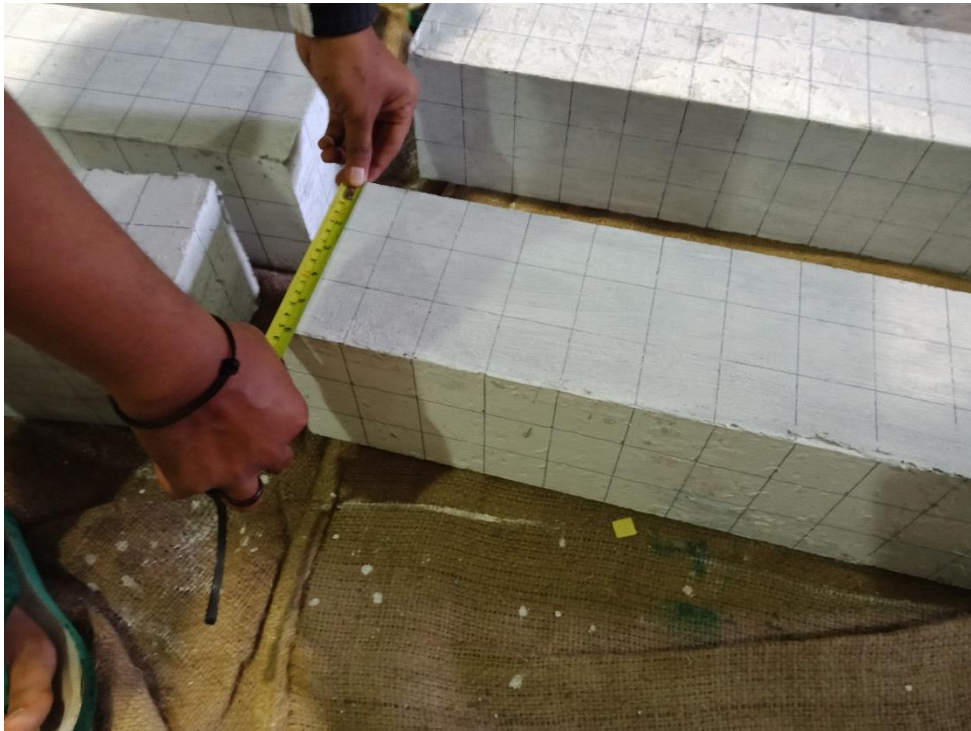
Gambar 31 pengukuran lebar benda uji balok
