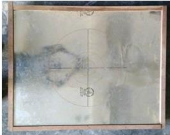
Gambar 14 Alat Pengujian T50
