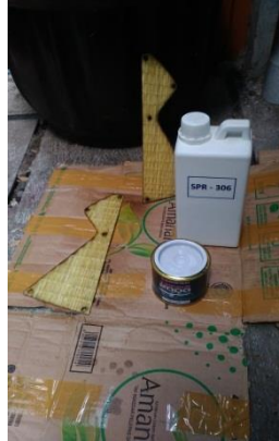
Gambar 3.8 proses pengecatan menggunakan cat clear
