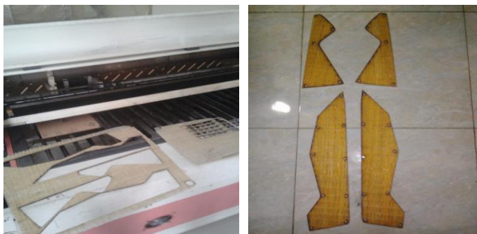
Gambar 3.7 proses pemotongan produk menggunakan laser
