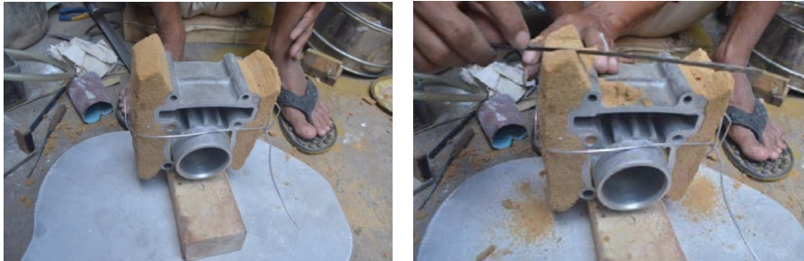
Gambar 7 pemberian gas \text{Co}^2 pada adonan pasir silika
