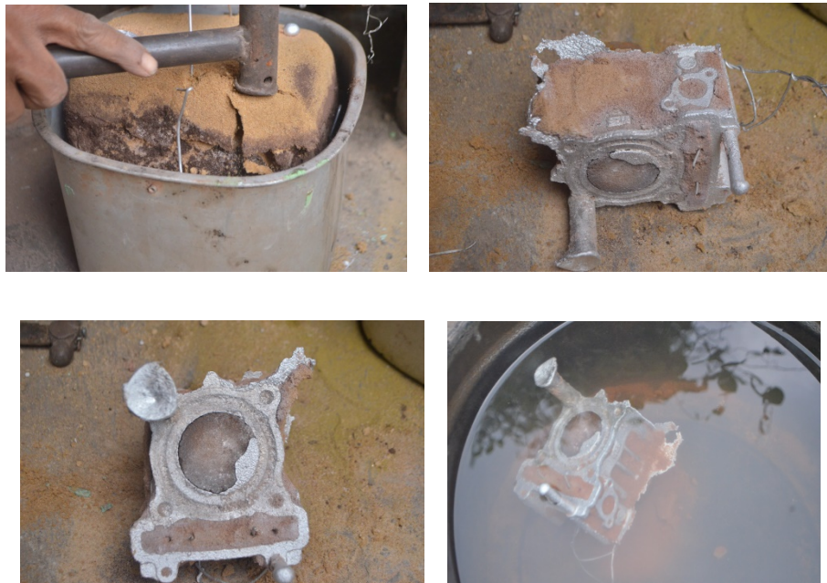
Gambar: 14 proses pembongkaran cetakan
