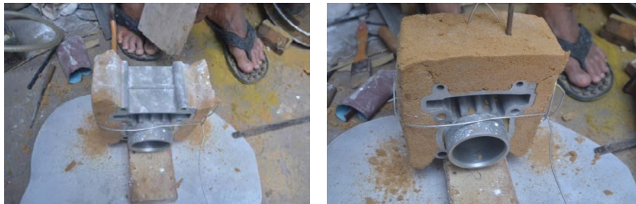
Gambar 7 pemberian gas \text{Co}^2 pada adonan pasir silika
