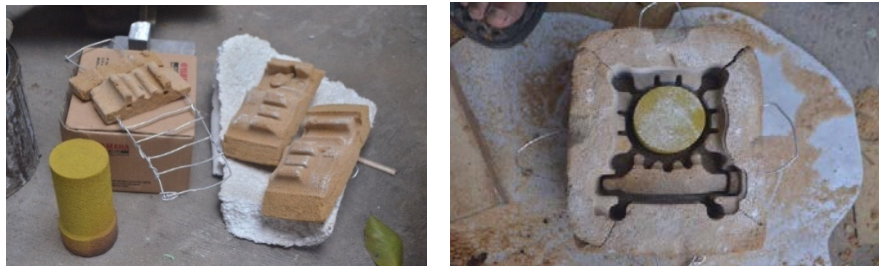
Gambar: 10 bagian-bagian cetakan dan proses pengikatan cetakan dengan kawat
